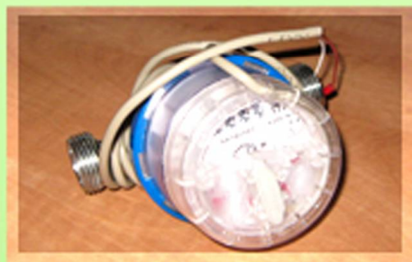
Счетчик холодной воды
